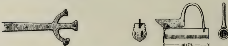
Fig. 15. Bork. Endigung des Türbandes und Vorhängeschloß.
